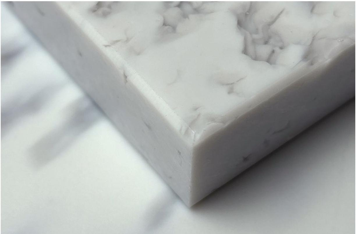
Unbehandelte Oberfläche mit sägerauer Schnittkante und 45° Kantenfräsung, Panel Design: [Mica]
